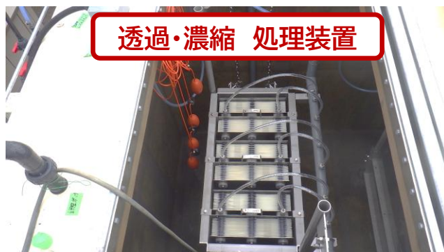
透過・濃縮の専用処理装置(特殊膜)
